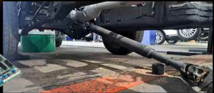
Der Antriebsstrang überträgt die Motorleistung auf die Räder.
